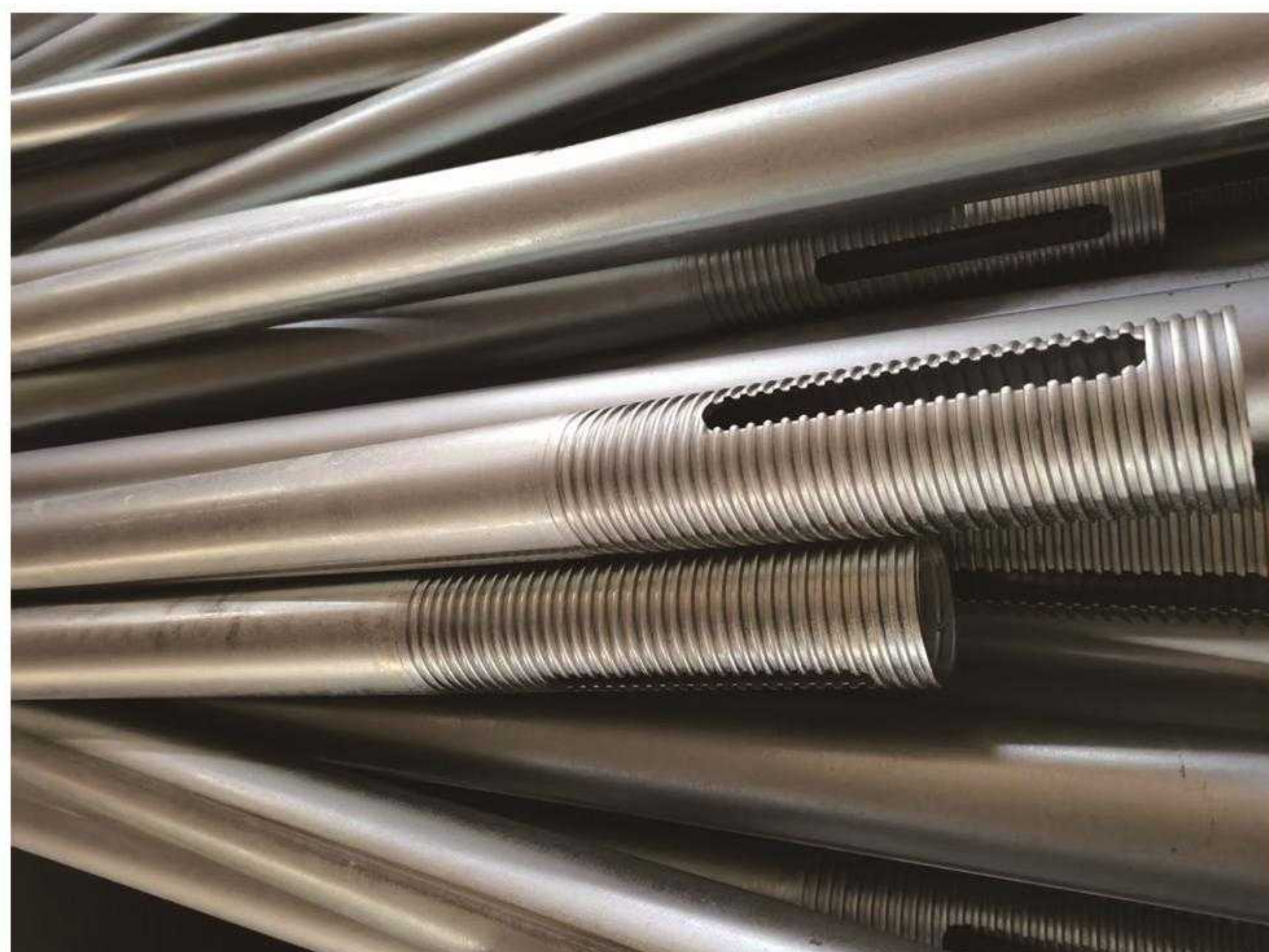
外管直接滚丝 non-welded prop
