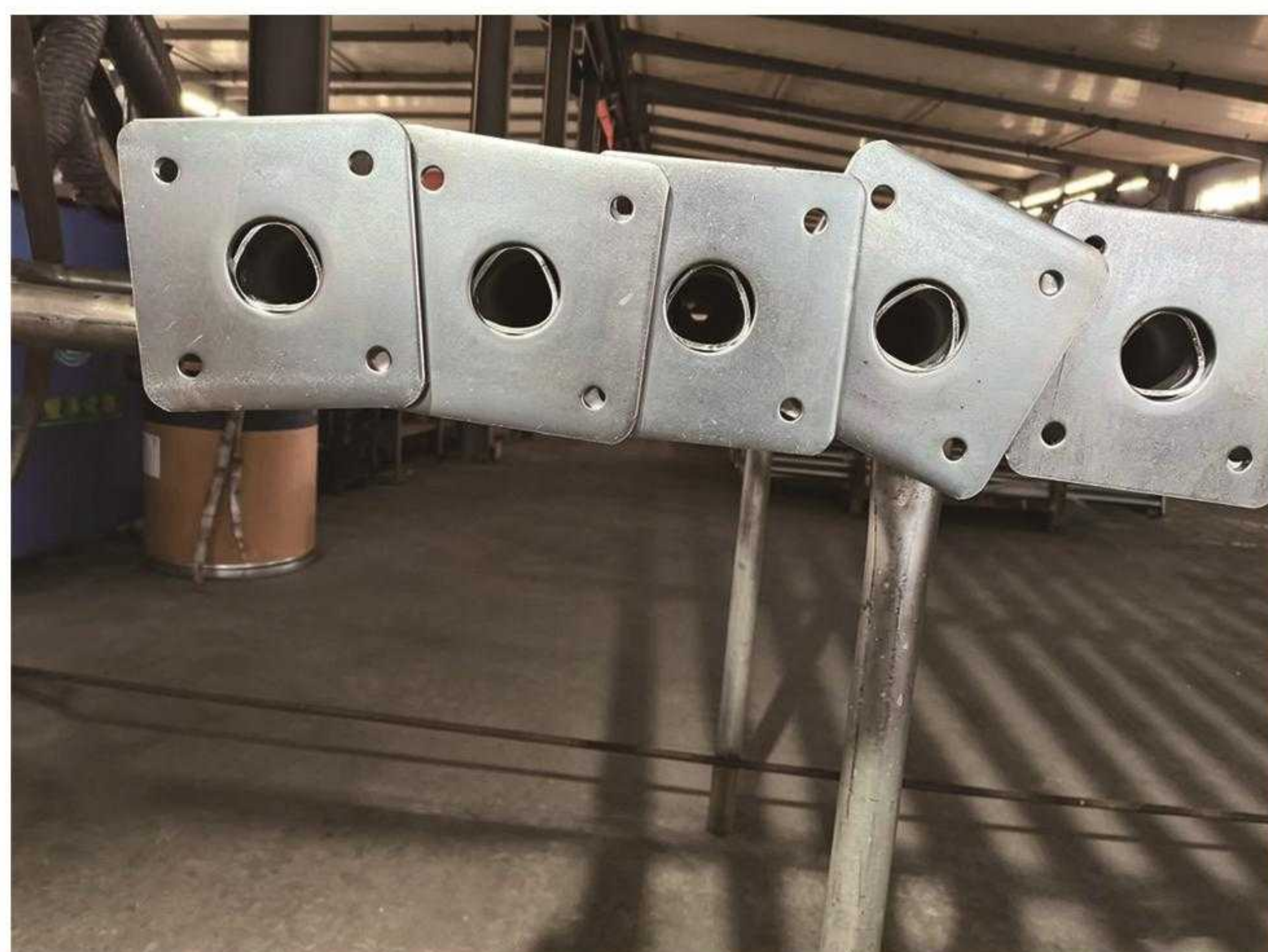
外管直接滚丝 non-welded prop
